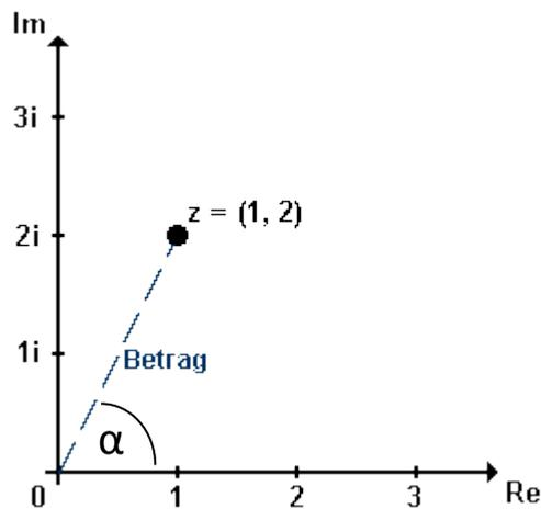
Hier werden die reellen und die komplexen Komponenten separat betrachtet. Alternativ können komplexe Zahlen auch durch ihren Betrag und einen Winkel, häufig als *Phase* bezeichnet, definiert werden. Der Betrag lässt sich analog zu dem eines Vektors berechnen:
