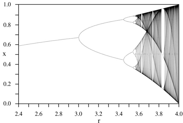
Die Stellen an denen sich der Grenzwert scheinbar „aufspaltet“ werden Bifurkationen genannt. Bei dem Diagramm handelt es sich demnach um ein Bifurkationsdiagramm. Gut zu erkennen ist die periodische Verkürzung des Bifurkationsintervalls, sowie der Übergang ins Chaos bei  $r \approx 3.57$ .
